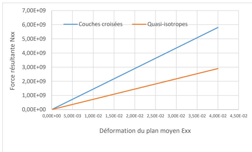
Figure III.10 : Tracé de la réponse de la force résultante de traction globale en fonction de la déformation du plan moyen ( N_{xx} - \epsilon_{xx}^0 ) pour les stratifiés graphite/époxy à couches croisées et quasi-isotropes à 150 °C.
