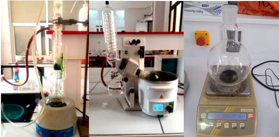
a) Extraction des huiles (Appareil Soxhlet) b) Evaporation (obtenir les huiles et récupération de solvant) c) Huile obtenue
