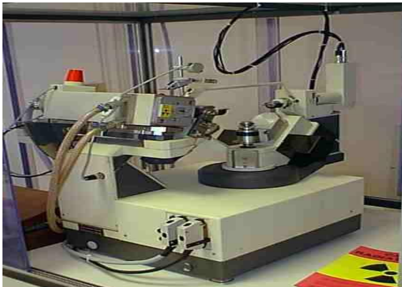
Figure II.1.c : Diffractomètre automatique CAD4 Nonius.
