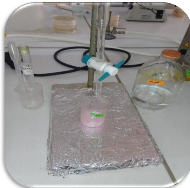
Figure21 : Mesure de l'acidité titrable
