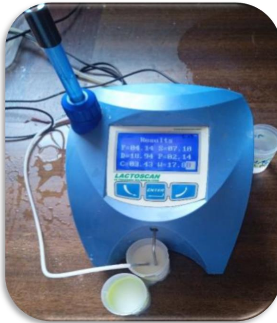
Figure 30 : l'appareille lactodensimètre « lactoscan (ultrasonic,N° :16161) ».
