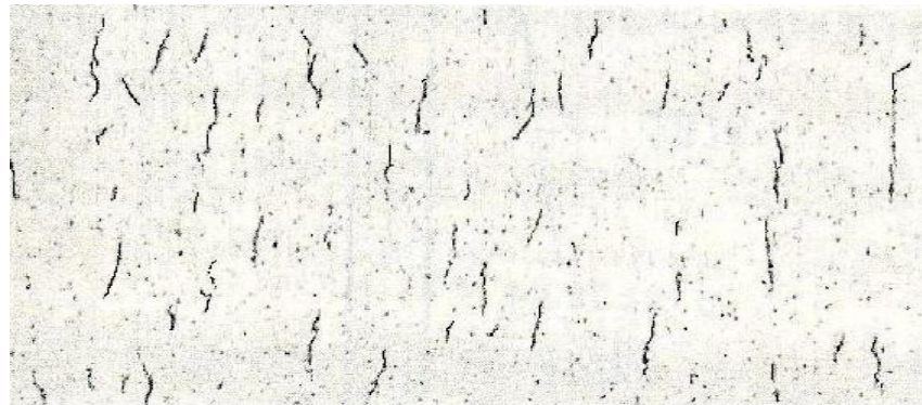
Figure N°31 : Observation des hydrures de Zirconium au microscope optique (G=120)
