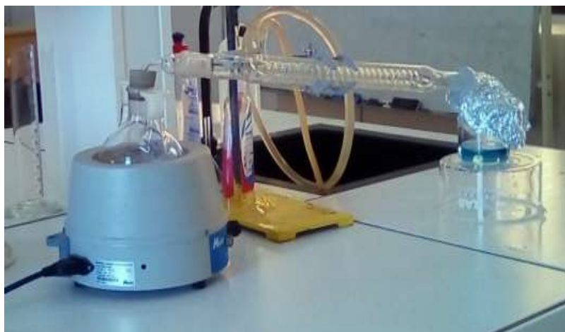
Figure 09: Montage de l'appareil de distillation. (Présent travail)
