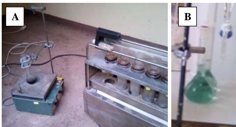
Figure 08. Montage de l'appareil de Kjeldahl. (Présent travail)
