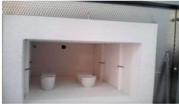
Figure 07: Les échantillons dans le Four à moufle (Type Nabertherm L5/11). (Présent travail)
