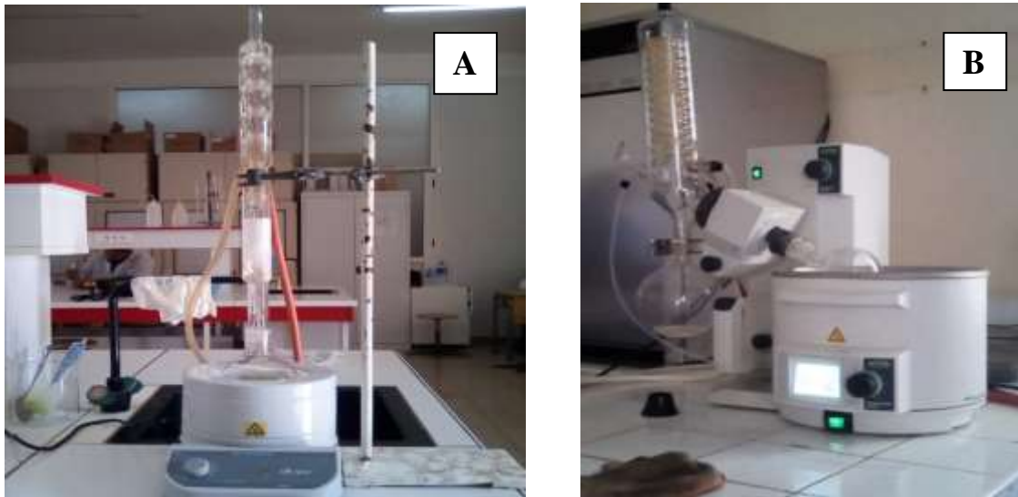
Figure 11: A) Montage de l'appareil de Soxhlet pour l'extraction des lipides. B) évaporateur rotatif. (Présent travail)
