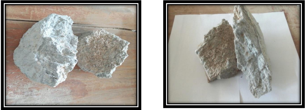
Figure II.13 : Séchage : L'échantillon est d'abord séché par passage à l'étuve (105 oc) afin d'éliminer toute éventuelle humidité et faciliter son broyage ainsi que son tamisage.
