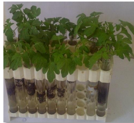
Fig.19 : Trempage des plants dans la solution de KNOP.
