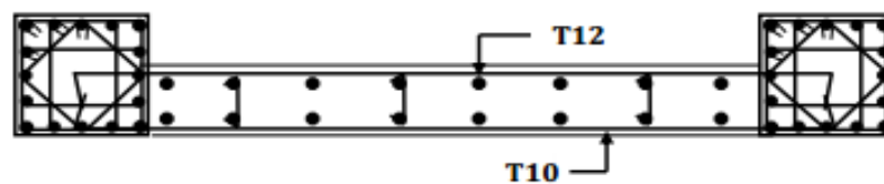
Figure V.7: Schéma de ferrailage du voile.
