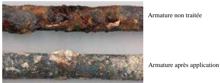
Figure 5.5 Armature après application d'un inhibiteur
