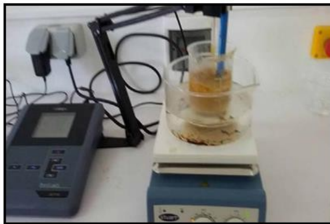
Figure 24: montage de l'appareil pour hydrolyse enzymatique des coproduits de thon rouge et coproduits de la crevette
