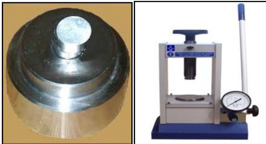
Figure 17: Les appareils utilisés pour la réalisation des pastilles.
