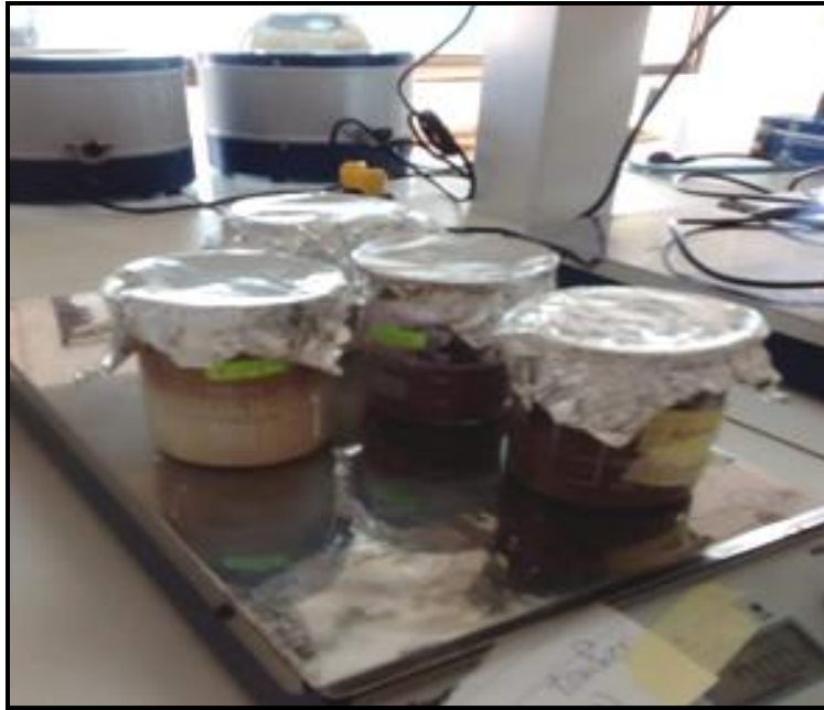
Figure 14: Traitement chimique à base de \text{NH}_4\text{H}_2\text{PO}_4
