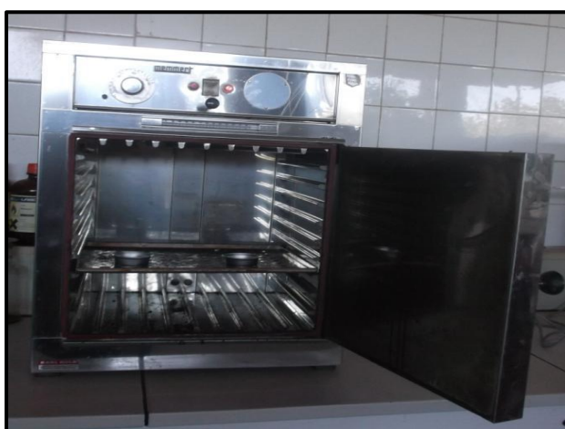
Figure III.4 : Etuve avec thermostat à 120°C.
