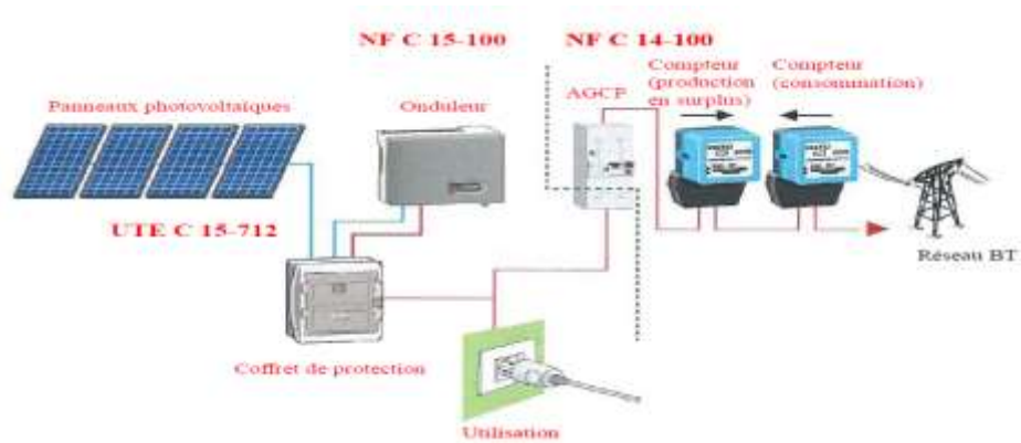
Figure I.7 : Injection énergie supplément dans le réseau
