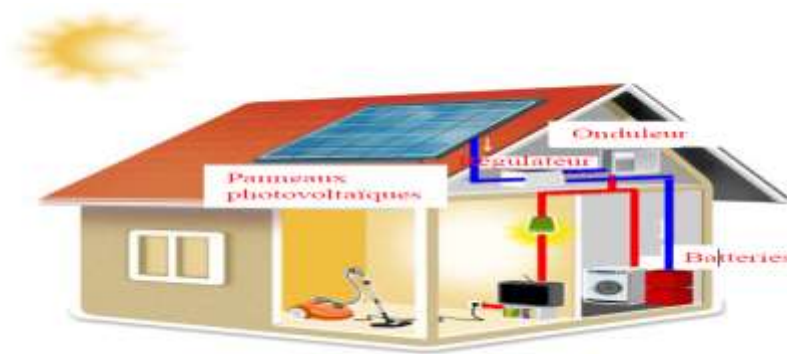
Figure I.3: Installation sur site isolé
