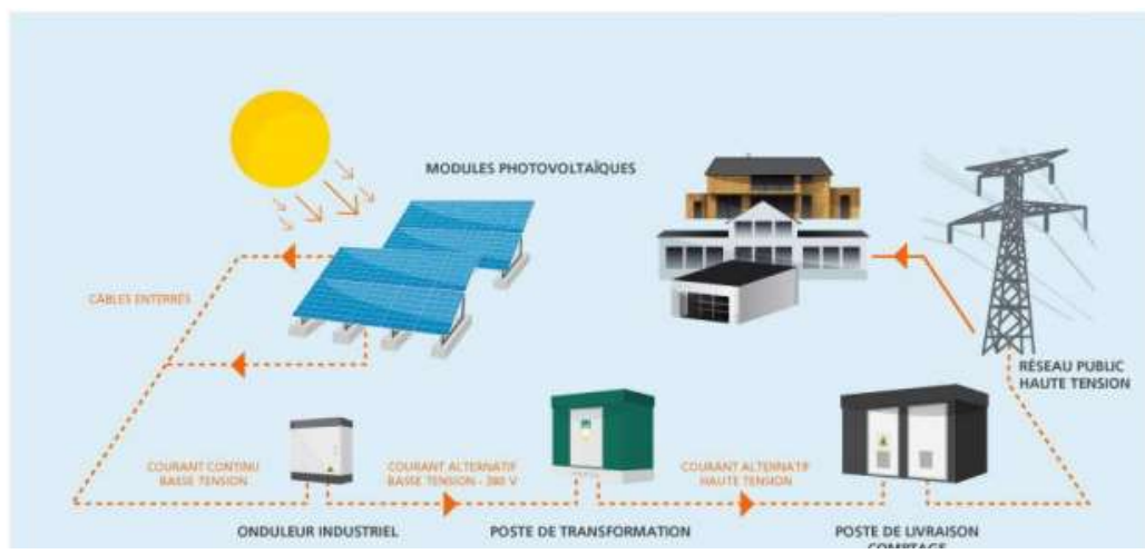
Figure I.1: Fonctionnement général d'une centrale solaire [2]
