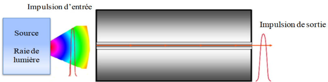
Figure 1.9 : fibre optique monomode. [5]
