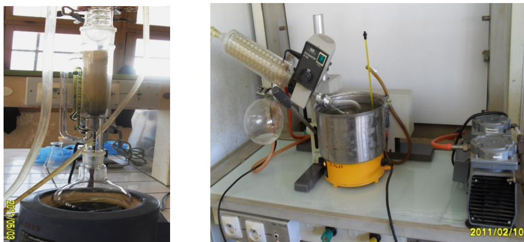
Figure n° 21: Soxhlet et Rotavapor utilisés dans cette étude.
