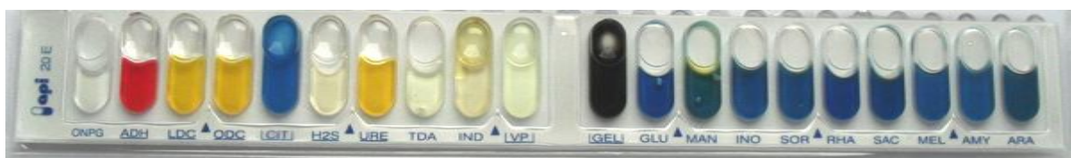
Figure n° 25: La galerie biochimique API 20 E après un ensemencement et incubation de 24h.
