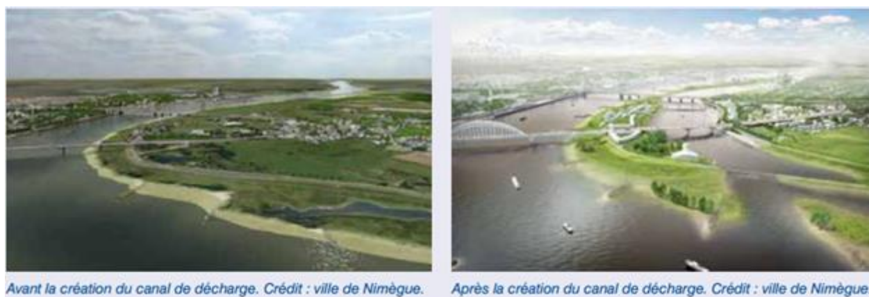
Figure 37 : Avant et après de la création du canal de décharge [21].
