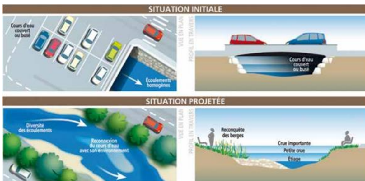
Figure 40 : Exemple de remise à ciel ouvert d'un cours d'eau en milieu urbain. Source : © Graphies - Onema.
