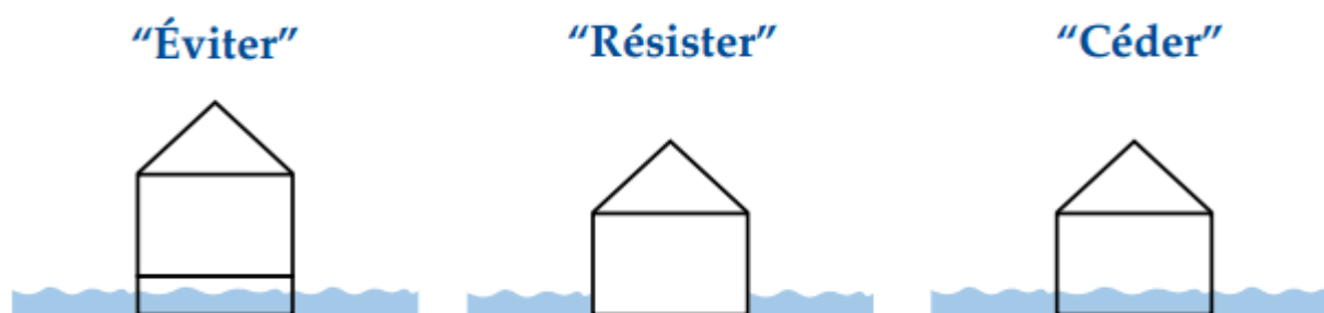
Figure 45 : Schéma montrant les stratégies d'adaptation des bâtiments à l'inondation [11].
