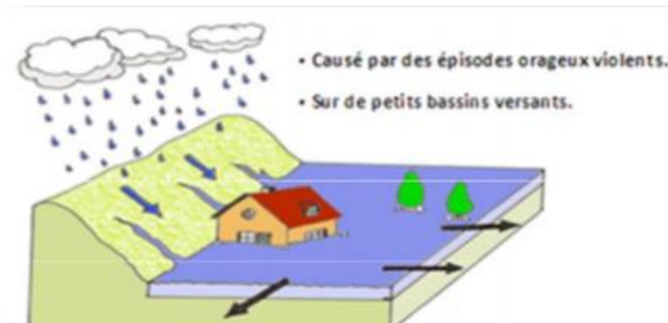
Figure 4 : Inondation par ruissellement en secteur urbain [16].
