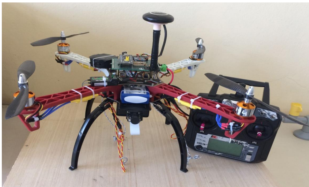
Figure III.2 : Notre réalisation de quad-copter
