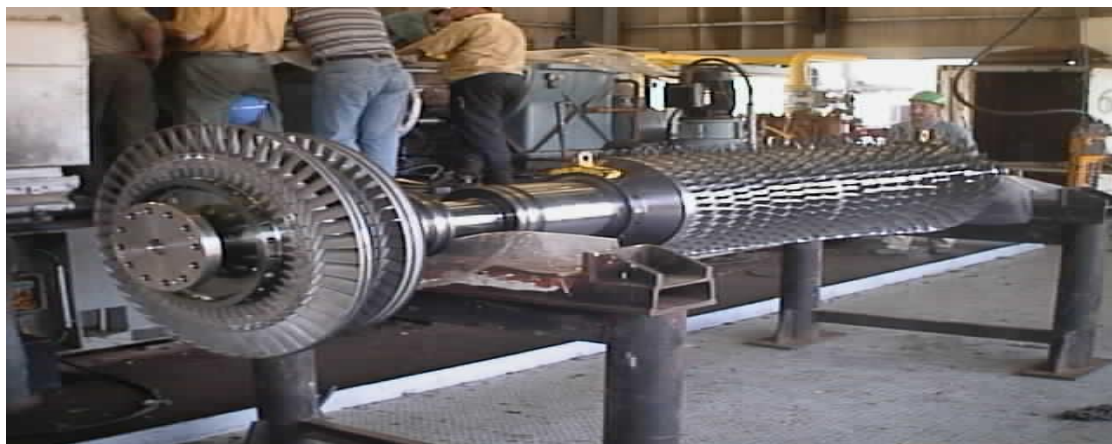
Figure. II.5. Compresseur d'air axial.
