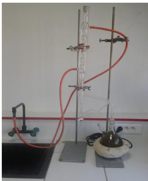
Figure 3: Montage d'hydrodistillation de type Clevenger utilisé en laboratoire [29].
