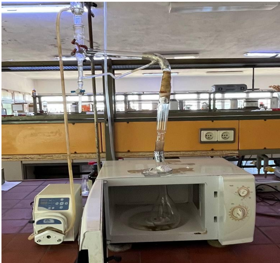
Figure 14 : Dispositif d'extraction assistée par microondes couplé à un extracteur de Clevenger.
