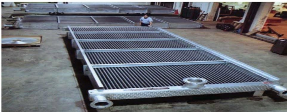
Figure III.5 : Faisceaux d'aéroréfrigérant en construction [4]
