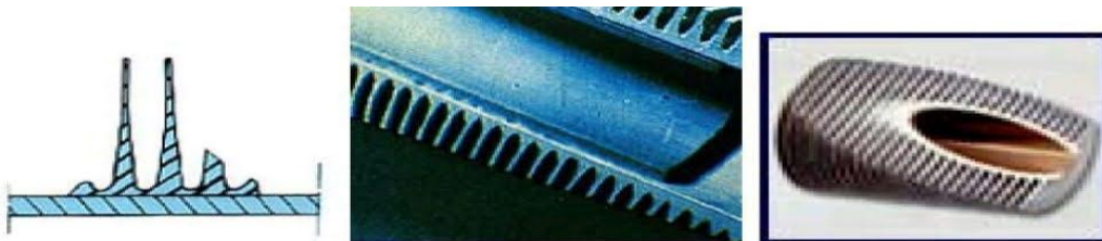
Figure III.8: Ailettes bimétalliques extrudées [4]
