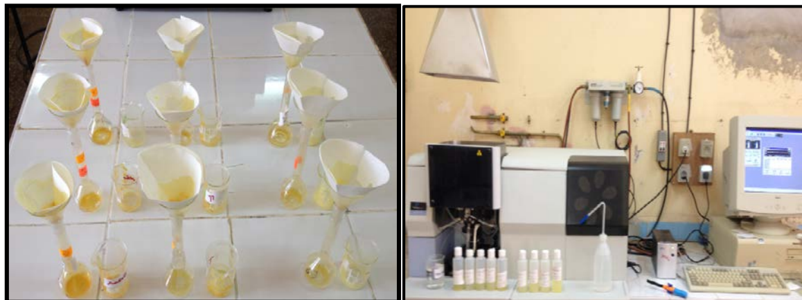
Photo 25 :la filtration des échantillons. Photo 26 :la lecture avec spectrométrie d'absorption atomique SAA.
