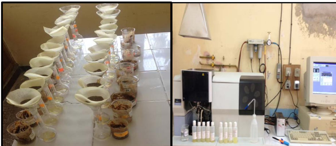
Photo 21: Dosage des échantillons par l'acide et puis la filtration. Photo 22: la lecture avec spectrométrie d'absorption atomique SAA.
