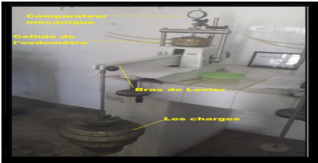
Figure I-13 : Appareillage de l'essai de compressibilité par palier l'œdomètre
