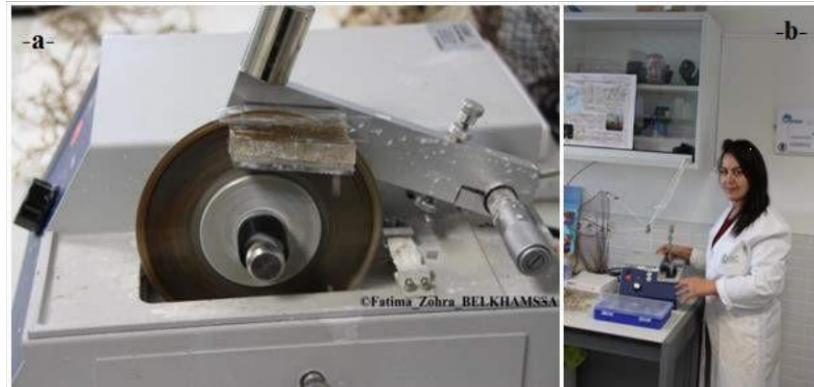
Fig. 44a-b : Découpe des lames fines à l'aide d'une microscie (BELKHAMSSA©2019)
