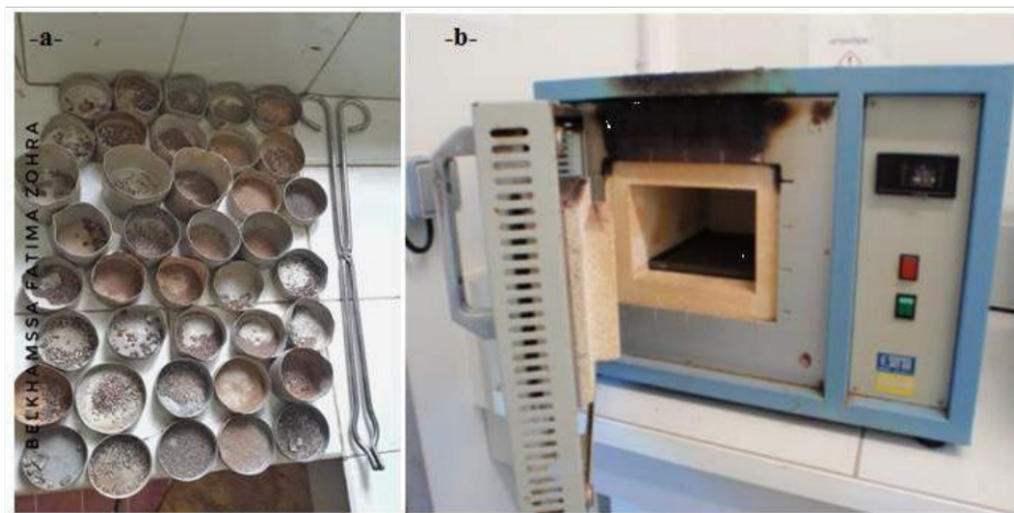
Fig.51a et b : Calcination des échantillons à 550°C dans un four à moufle de marque Nabertherm , modèle L3/11 (BELKHAMSSA©2019).
