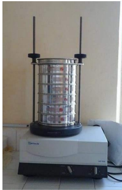
Fig. 47 : Tamiseuse de marque Retsch , modèle AS200 et colonne de tamis (BELKHAMSSA©2019).
