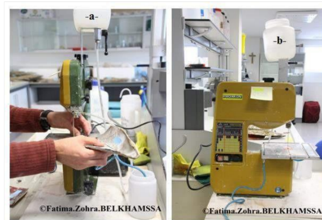
Fig. 38a et b : Coupes de nacre ( Pinna nobilis ), à l'aide d'une scie à ruban Proxxon Micromot MBS 240/E (BELKHAMSS©2019).
