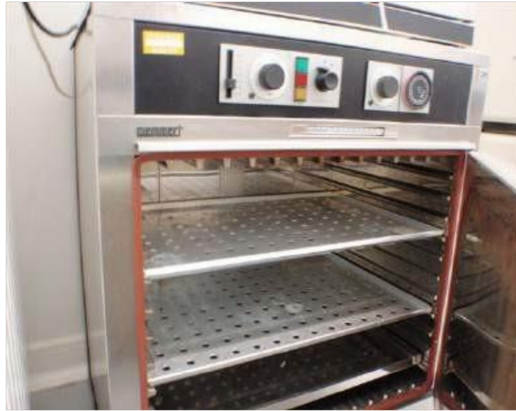
Fig. 46 : Étuve de marque Memmert, modèle IN55plus (BELKHAMSSA©2019).
