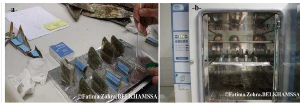
Fig. 43a et b : Collage des coupes polies de Pinna nobilis et séchage au four à moufle (BELKHAMSSA©2019).
