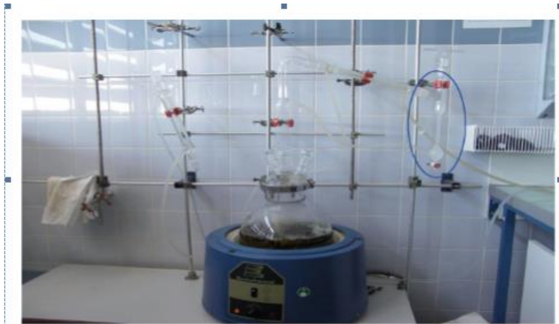
Figure 2: Montage d'hydrodistillation (clevenger) (J.Smadja, 2009)
