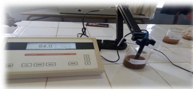
Photo 16 :test de conductivité électrique
