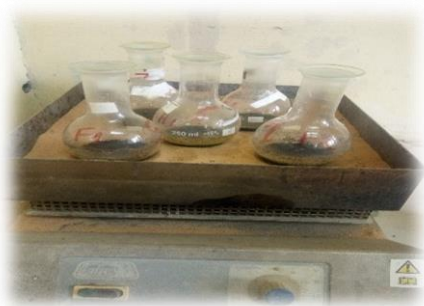
Photo 18 : dosage de carbone et matière organique
