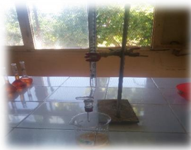
Photo 18 : dosage de carbone et matière organique
