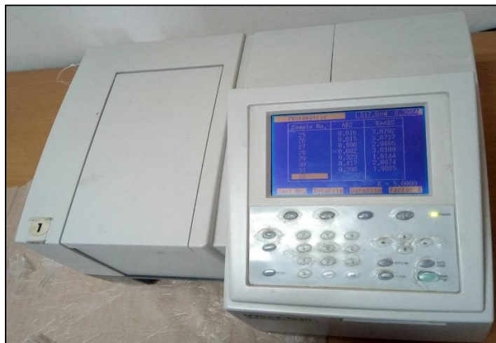
Figure 24 : Spectrophotomètre utilisé pour la lecture des absorbances.
