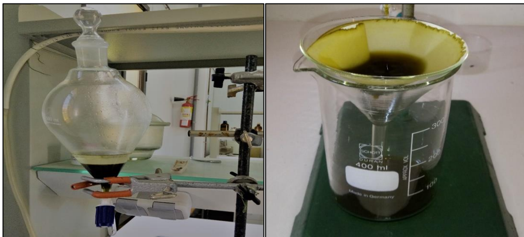
Figure 26 : Décantation et filtration de la phase inférieure,
