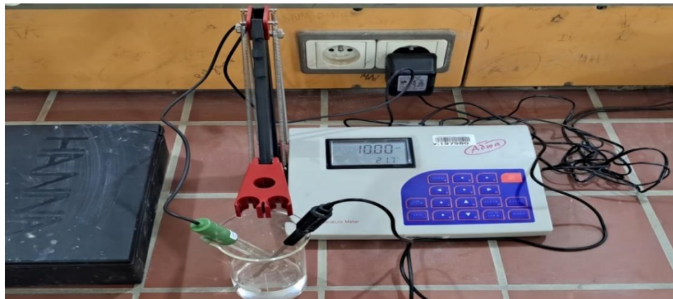
Figure III-10: L'essai de mesure du Ph
