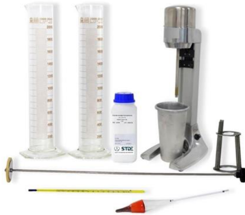
Figure III-7: Essai de sédimentométrie.
