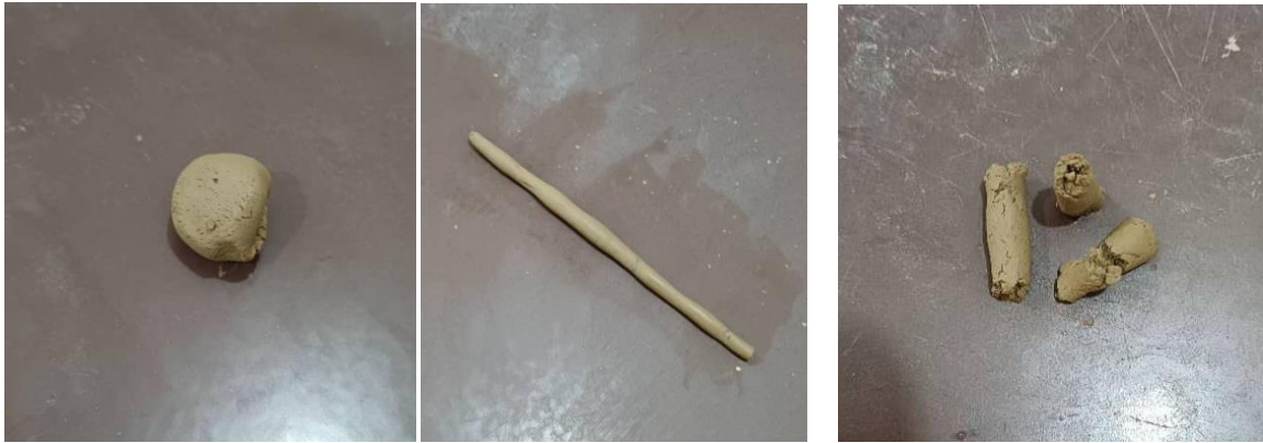
Figure III-5: La procédure pour détermination de la limite de plasticité
