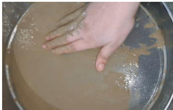
Figure III-2: Tamisage par voie humide à 400 \mu\text{m}
