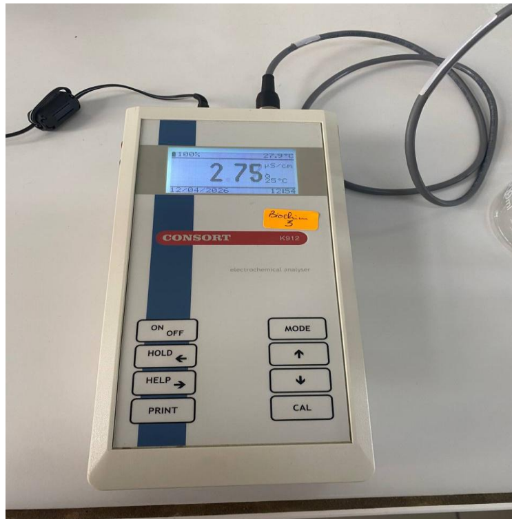
FIGURE 17: MESURE DE LA QUALITE DE L'EAU AVEC UN CONDUCTIMETRE .SOURCES (BOUJNAAH NOURHANE ET BOUDRAF AICHA 2026)
