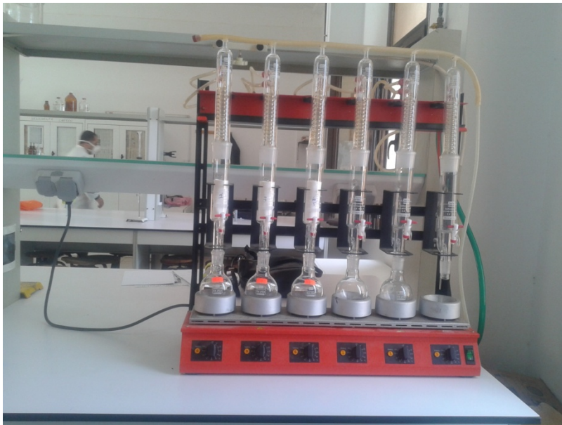
Photo N°21 Extracteur de l'appareil de Soxhlet
