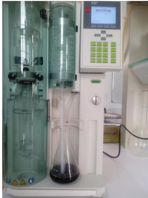
Photo N°22 Distillateur semi automatique Kjeldahl
