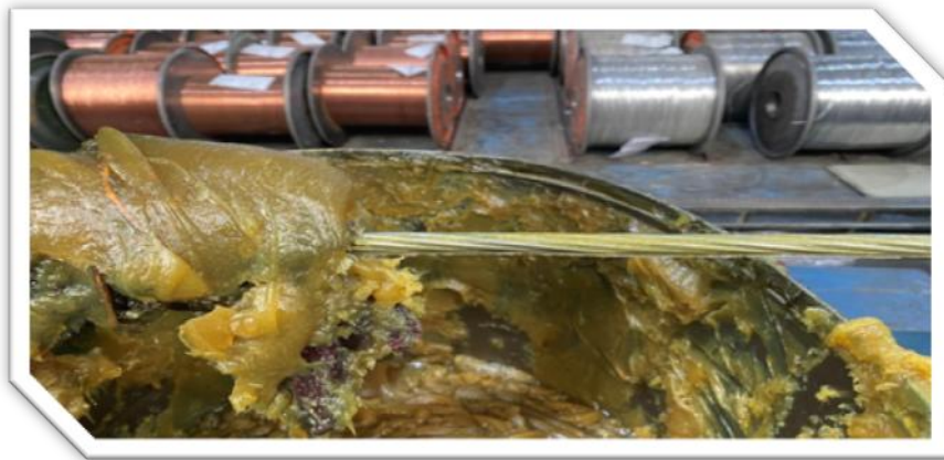
Figure III.1 : application de la graisse sur un fil d'aluméc
