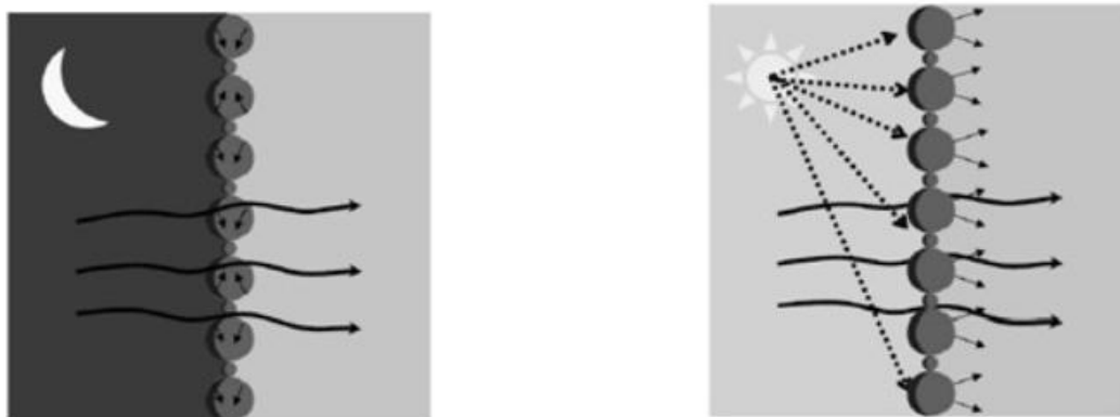
Figure 20: L'effet rafraîchissant du moucharabieh par le processus d'évapotranspiration (Source: Özsavaş Akçay & Alotman, 2017)
