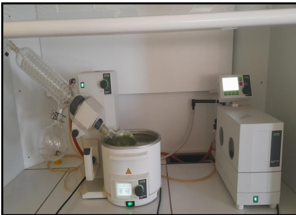
Figure 7. Etape d'évaporation sous-vide et de récupération de l'extract pur hydroéthanolique de Laurus nobilis L
