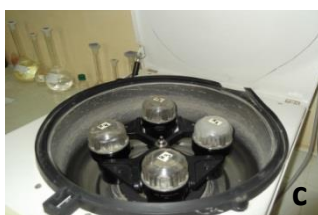
Photos 4 (c et d). Extraction des sels par Centrifugation et Filtration (Extrait saturé)
