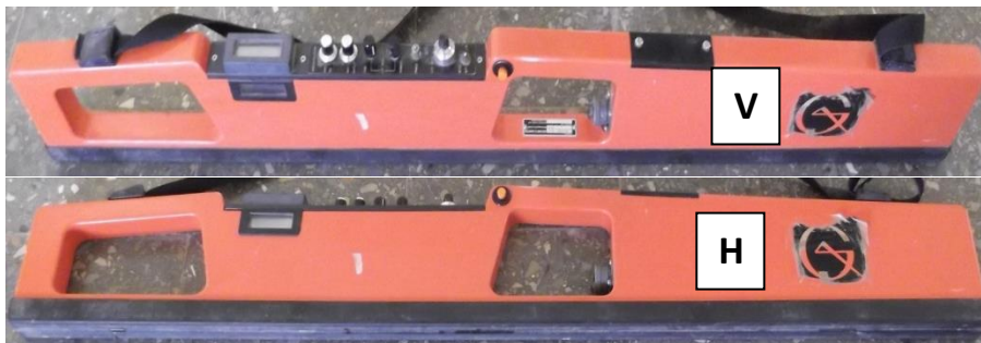
Figure 8. Conductivimètre électromagnétique EM-38 en mode vertical (V) et horizontal (H)
