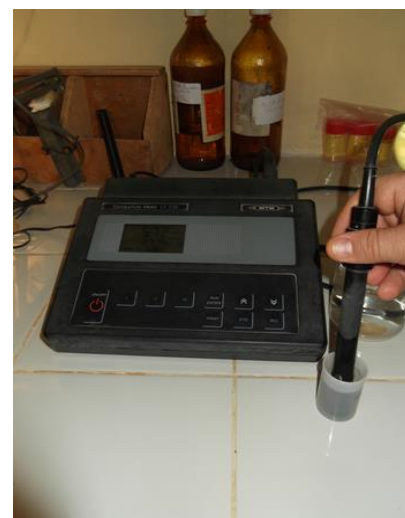
Photo 5. Mesure de la CE de l'extrait obtenu.
