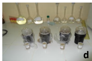
Photos 4 (c et d). Extraction des sels par Centrifugation et Filtration (Extrait saturé)
