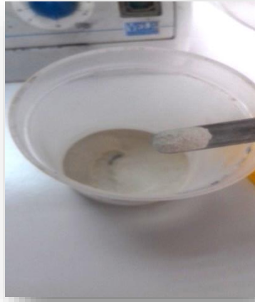
Figure III.3 : la Maghnite-H + après le séchage et le broyage
