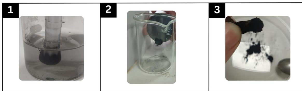
Figure V.3. Mise en évidence expérimentale de la magnétisation et de la séparation magnétique du composite MCO sous l'effet d'un champ magnétique externe.
