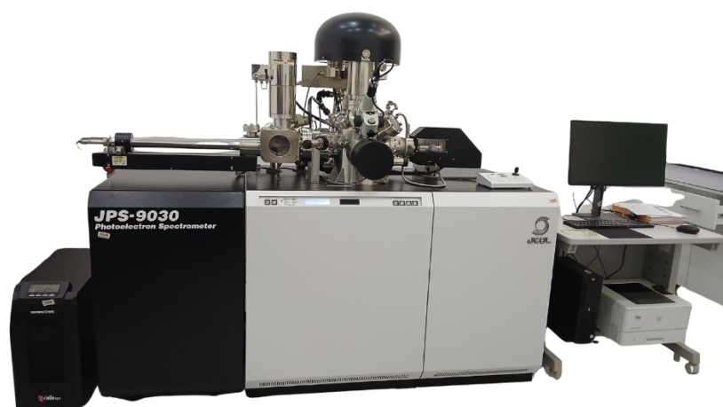
Figure IV.12. Spectromètre XPS JEOL JPS-9030 (image prise par BENHADDA A.).
