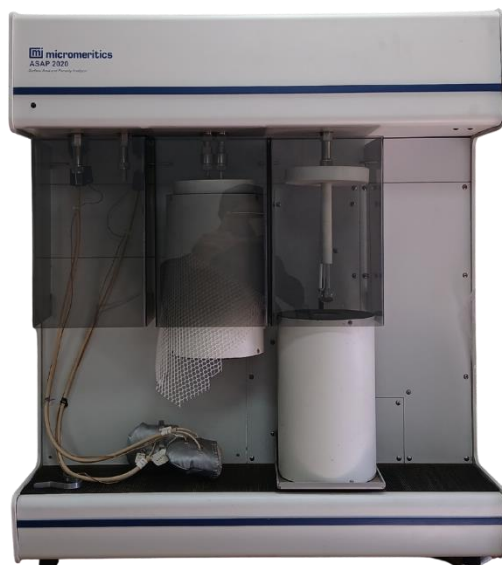
Figure IV.11. Analyseur de surface spécifique ASAP 2020 de Micromeritics (image prise par BENHADDA A.).
