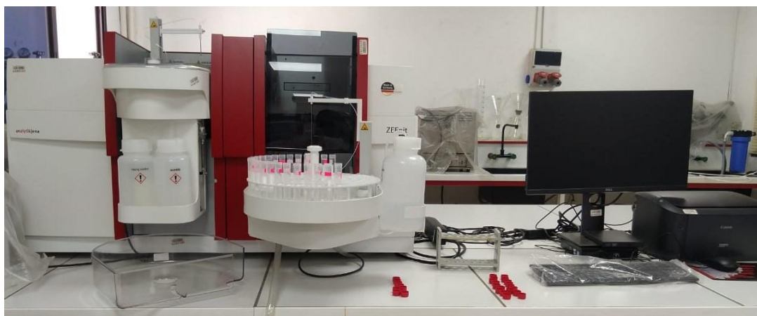
Figure IV.14. Spectromètre d'absorption atomique (SAA) de type ZEEnit 700 P utilisé pour la détermination du cuivre.
