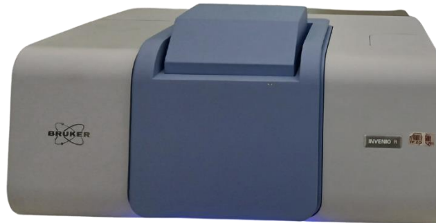
Figure IV.8. Spectromètre Bruker muni d'un accessoire ATR (Attenuated Total Reflectance) (image prise par BENHADDA A.).
