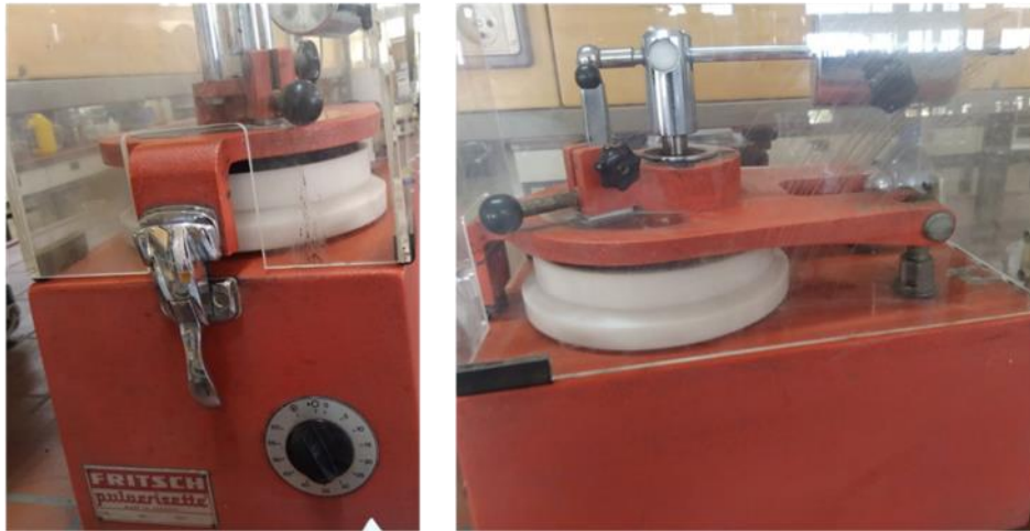
Figure IV.6. Broyeur mécanique Fritsch Pulverisette (modèle 02.102) employé pour la préparation des composites.
