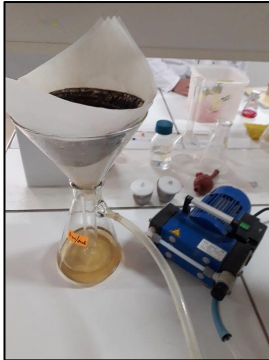
Figure 21 : filtration et rinçage de la matière broyé.
