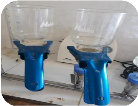
Figure n°IV.2 - Test MES pour l'eau brute et épurée.
