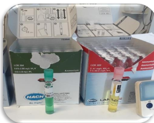
Figure n°IV.16 : résultat Teste en cuve de l'ammonium.
