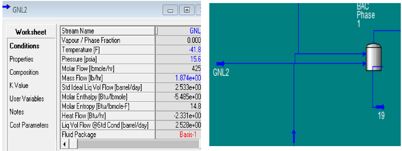
Figure IV.6 : Vérification du propane de GL2Z.
