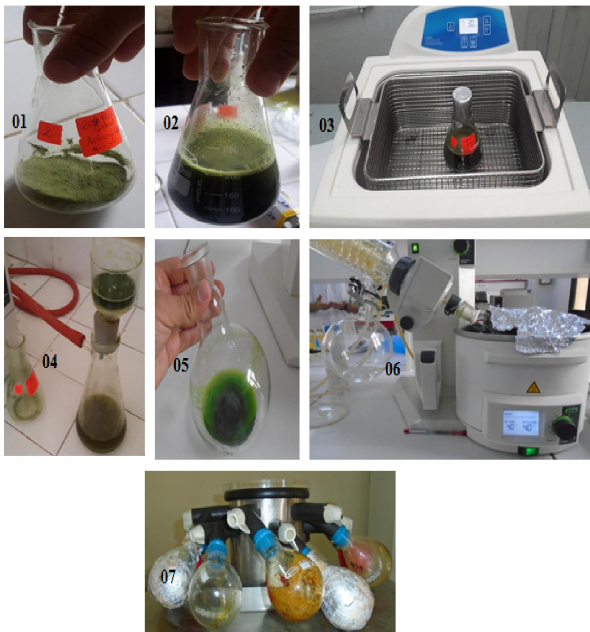
Figure 20 : Les étapes d'extraction par sonication : 01 : Broyé, 02 : Suspension (broyé + solvant), 03 : Sonication, 04-05 : Filtration, 06 : Evaporation (évaporateur rotatif), 07 : Lyophilisation.
