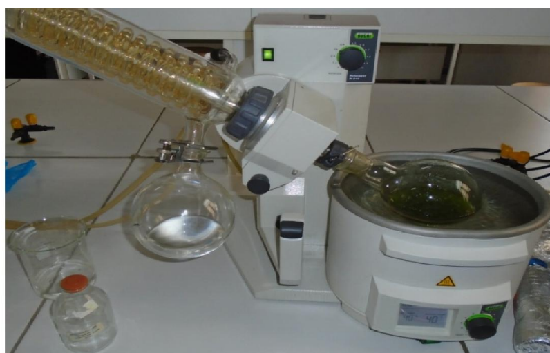
Figure 22 : Evaporation rotatif de l'extrait hydro-méthanolique de la menthe (Originale 2017)
