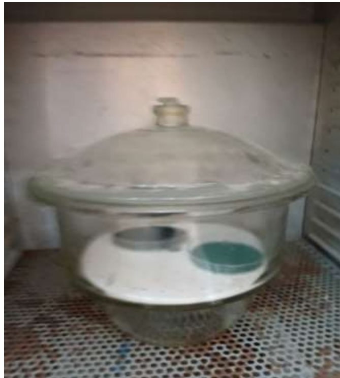
Figure.11 : Refroidissement dans le dessiccateur (Azzouz, 2025).
