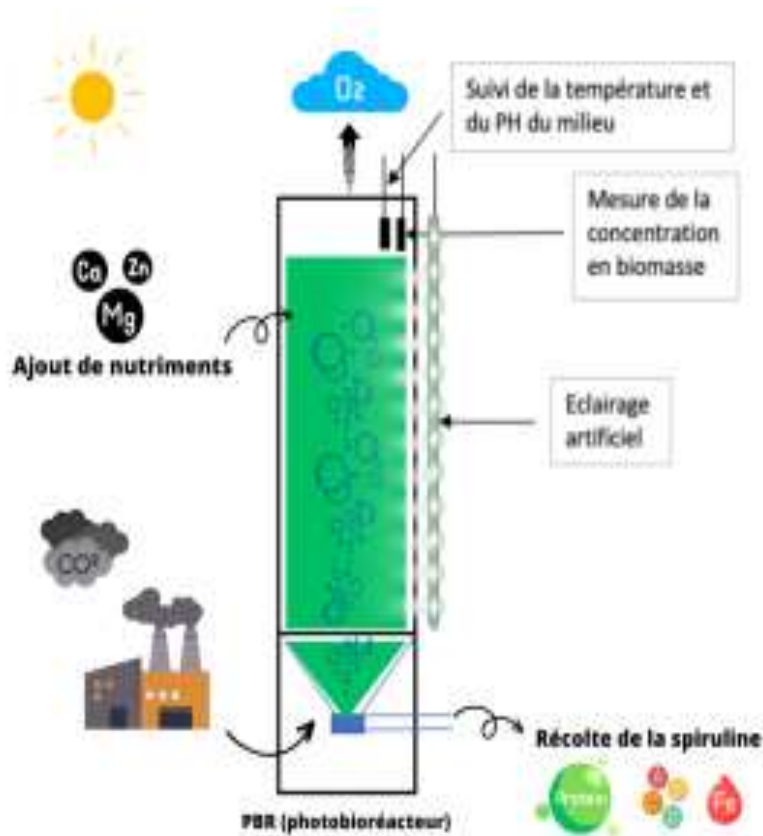
Figure.06 : Schéma de fonctionnement d'un photobioréacteur (Maximilien, 2023).
