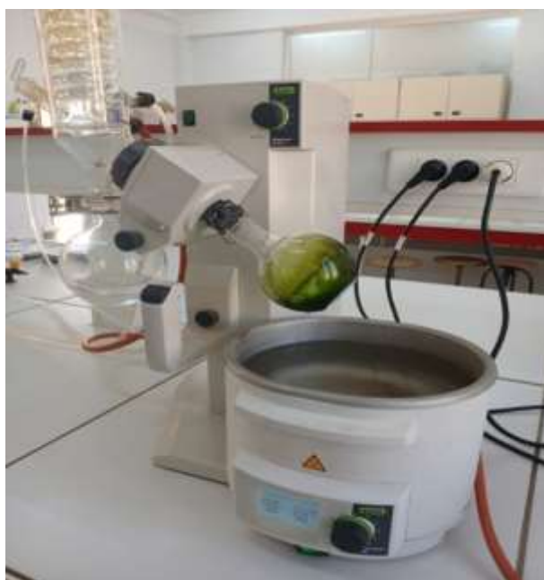
Figure.13 : Evaporateur rotatif utilisé pour l'évaporation du solvant (Azzouz, 2025)
