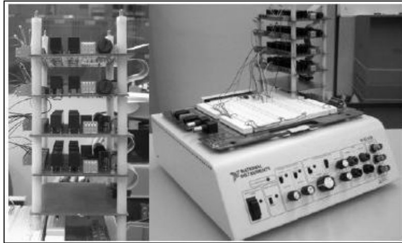
Figure 15: la plate-forme matérielle de RemotElectLab.
