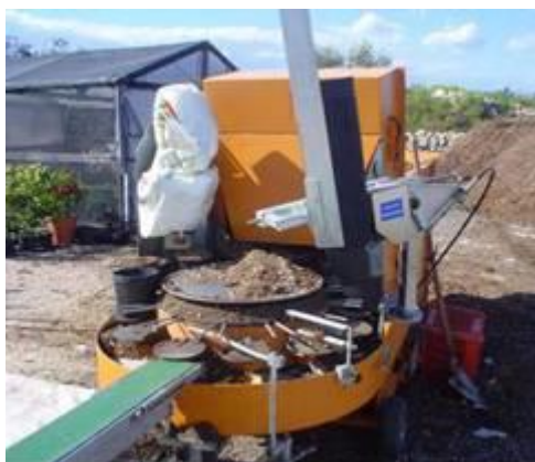
Figure 53. Machine "à repoter" et boutures de racines d'olivier à peine repiquées dans les pots.
