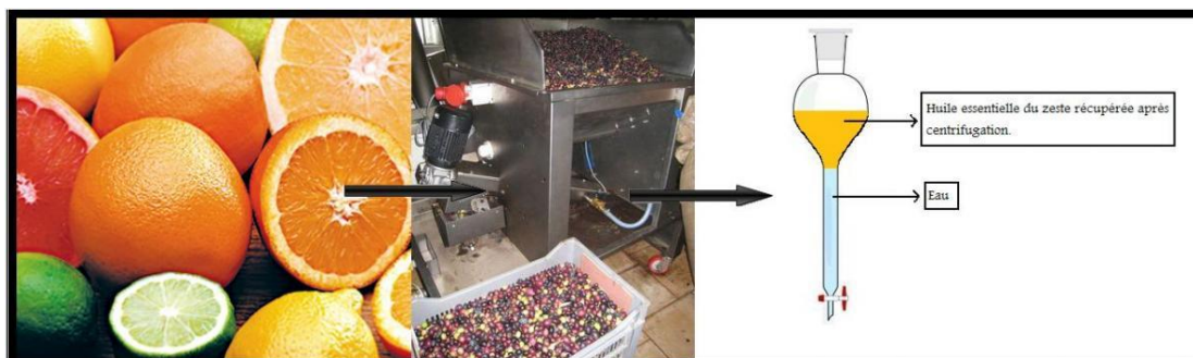
figure n°05 : Schéma de l'extraction par expression à froid
