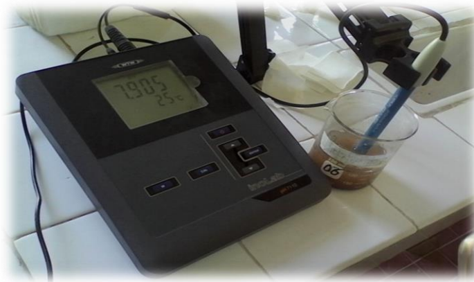
Photo 17: La lecture du PH se fait moyennant par un PH-mètre
