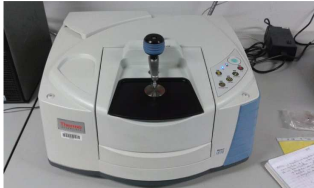
Figure 42. Spectrophotomètre FTIR utilisée.
