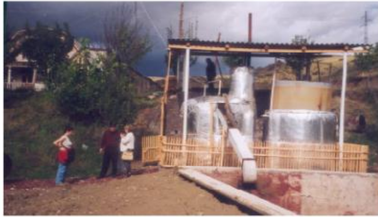
Photo 1. Digesteur anaérobie traitant du lisier avec valorisation du biogaz par alimentation d'une cuisinière (Géorgie) (Stuckey 1998).
