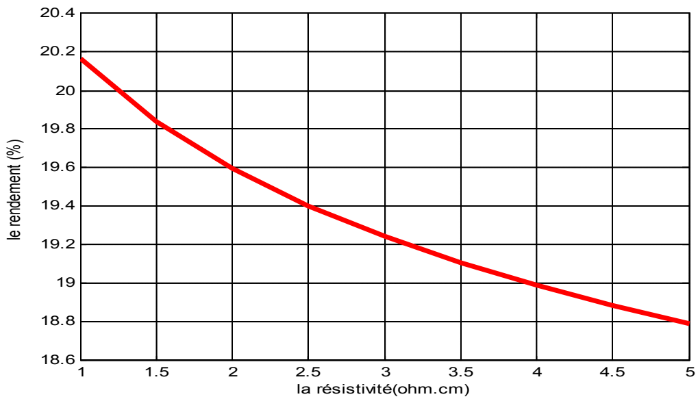
Figure 63 - La variation de rendement \eta numérique en fonction de \rho .
