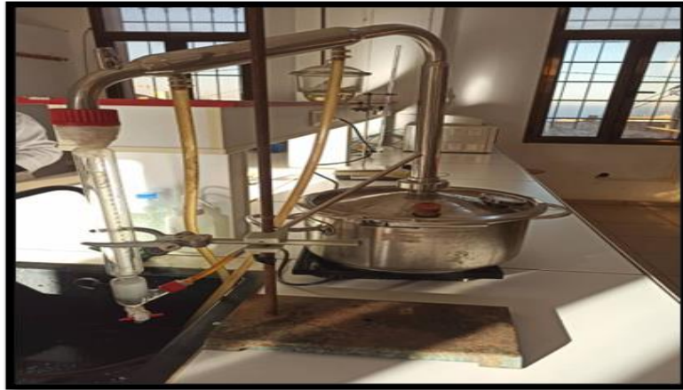
Figure 10 : Extraction de l'huile essentielle par entraînement à la vapeur (photo personnelle, 2025).
