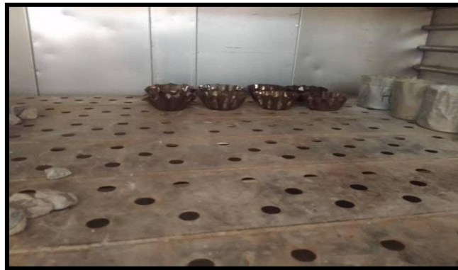
Figure IV.4 : Essai d'étuvage du sol
