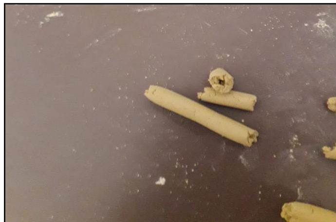
Figure IV.9 : Essai de limite de plasticité
