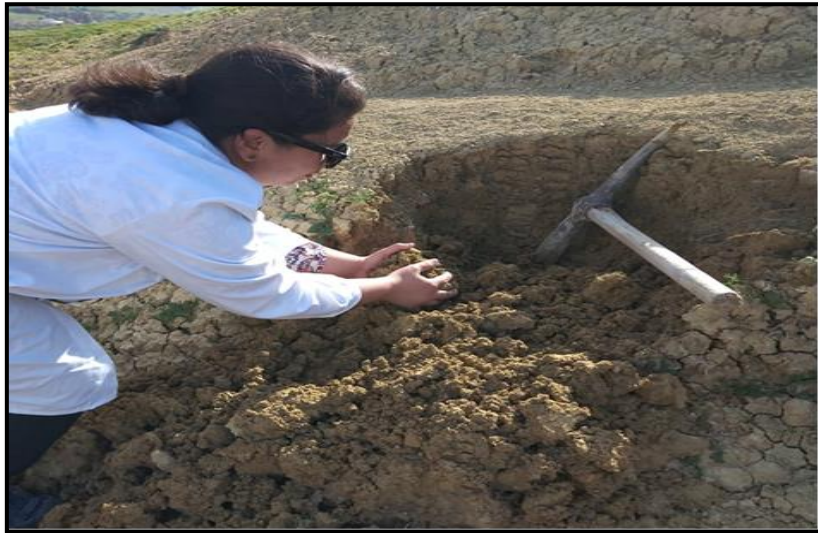
Figure IV.3 : Prélèvement de sol
