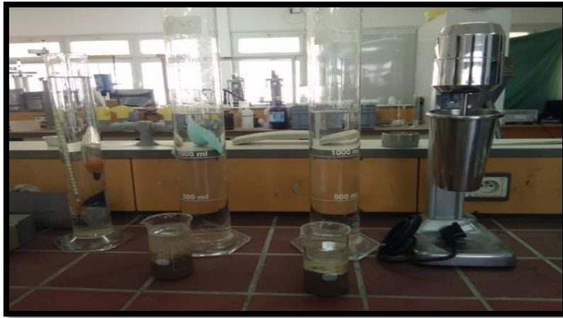
Figure IV.5 : Essai de sédimentométrie
