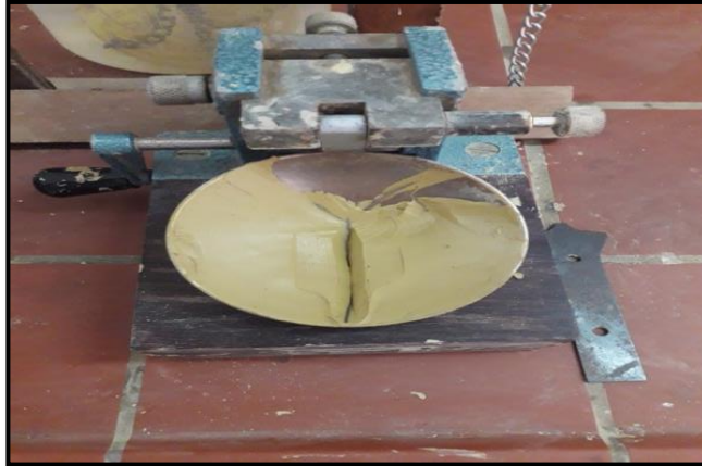
Figure IV.8 : Essai de limite Atterberg (appareil de Casagrande)
